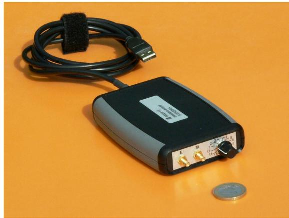
L'appareil Z-Scope V5™ est un appareil d'analyse d'impédance à technologie numérique. Il fournit un signal d'excitation sinusoïdal pour un capteur et reçoit en retour le signal de sortie du capteur. Branché sur le port USB d'un PC, il permet d'utiliser la plus part des capteurs qui fonctionnent sur le principe excitation/mesure, tels que les capteurs inductifs, capacitifs, pont de résistances, etc.
